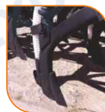
НАРАЛЬНИК 45 мм ИМЕЕТ 2 ПЛАСТИНЫ. ПО МЕРЕ ИЗНОСА НИЖНЕЙ ЧАСТИ ЕГО РАЗВОРАЧИВАЮТ НА 180 ГРАДУСОВ И ДАЛЬШЕ ИСПОЛЬЗУЮТ
