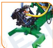
Поворотное дышло с двухточечной навеской
