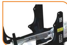
Стойки устанавливаются непосредственно на лонжероны трактора.
