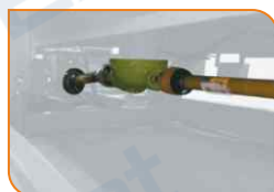
2 конических угловых редуктора с планетарным механизмом
