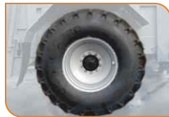
Шины больших размеров (650 / 75 R32)
