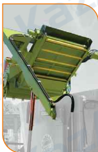
Транспортер фрезы цепной с катковой цепью
