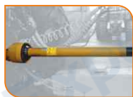
Широкоугольный карданный вал с фрикционной предохранительной и обгонной муфтами
