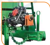
Предохранительная опора с эластичной муфтой
