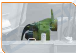
Понижающий двухступенчатый редуктор
